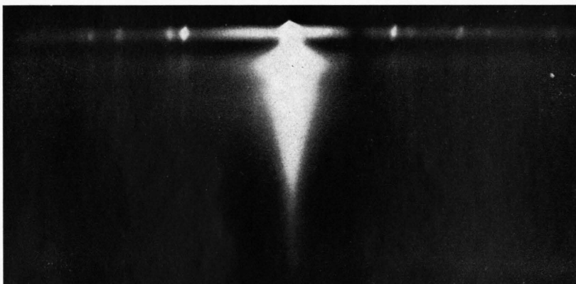
Abb. 14. Geschwindigkeitsdiagramm eines Debye-Scherrer-Bildes, Analysatorspalt auf 10\ \mu zugezogen. (Spektrum 2,4-fach vergrößert.)
