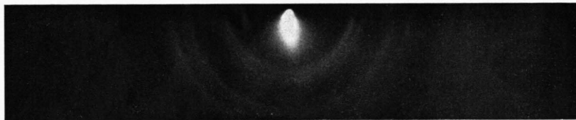
Abb. 11. Interferenzbild auf Bildschirm B_4 , Analysatorspalt geöffnet und seitlich von der Achse verschoben, Interferenzbild ist nicht ganz zentral in den Spalt eingeschossen. (2-fach vergrößert.)
