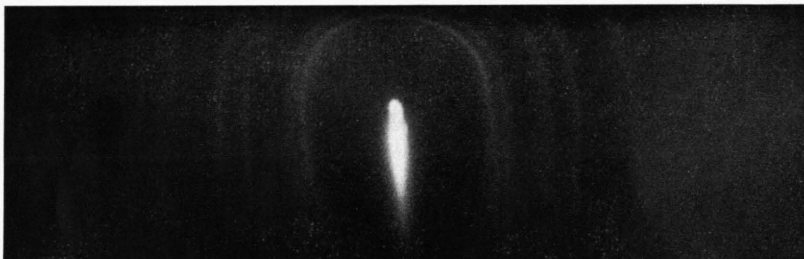
Abb. 13. Interferenzbild auf Bildschirm B_4 , Analysatorspalt weiter als in Abb. 12 seitlich verschoben. Ganze Abbildung erfolgt, soweit sichtbar, im Bereich des zweiten Bildes. (2-fach vergrößert.)
